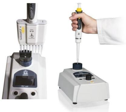
Si bien la unidad PLT no puede reemplazar las pruebas gravimétricas regulares, las comprobaciones diarias de las pipetas pueden proporcionar una protección durante los períodos entre calibraciones. ¡Incluso se detectan las fugas más pequeñas! De este modo se mejora significativamente la fiabilidad del proceso de las pipetas.
