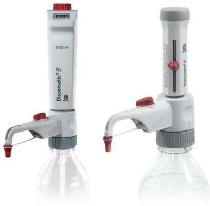
Dispensette® S (código de color rojo): ideal para dispensar reactivos agresivos, incluidas bases y ácidos concentrados como  $H_3PO_4$ ,  $H_2SO_4$  (excepto, por ejemplo,  $HCl$ ,  $HNO_3$  y  $HF$ ), soluciones salinas, así como muchos disolventes orgánicos.
