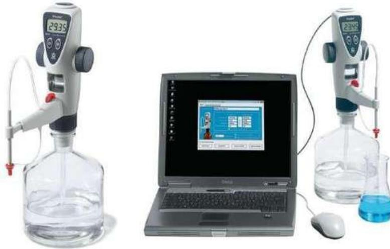
Seripettor Seripettor® y seripettor® pro son innovadores dispensadores de tapa de botella de BRAND con un diseño especial. Un resorte de elevación proporciona un llenado automático. Cuando el sello del pistón está desgastado, el usuario puede cambiar toda la unidad de dispensación de forma rápida y sencilla.
